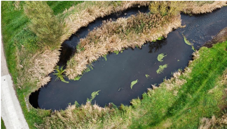
Abb.: Aus der Vogelperspektive - Sandfang mit Umgehungsgerinne in der Sorgeniederung © M. Stanisak
